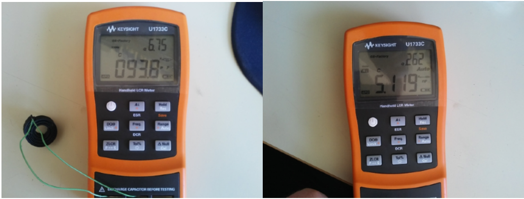
Слика 5. Капацитивност кондензатора када је диелектрик ваздух и вода.
