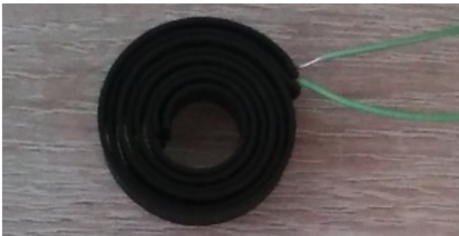
Слика 3: Фотографија произведеног намотаног кондензатора са доданим контактима.
