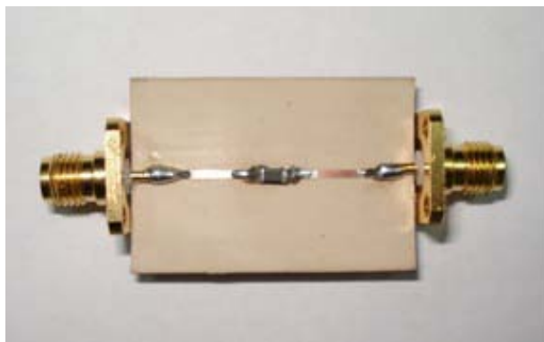
Слика 5. Микрострип прилагодни тест степени са постављеним SMD компонентом са: два краја – EMI потискивачем и б) три краја – LC EMI филтром у стандардном 0805, односно 2012 кућишту.
