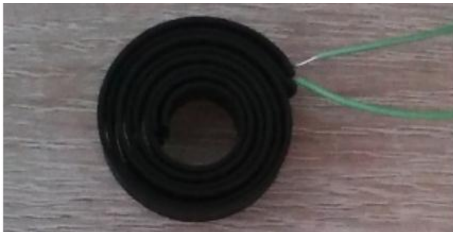
Слика 2: Фотографија произведеног намотаног кондензатора са додатим контактима.
