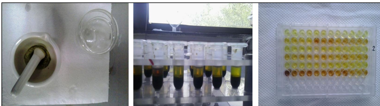
Slika 16. Spremanje uzoraka i ploča sa uzorcima za određivanje ukupnih karotenoida (Izvor: M. Stojanović, 2017)
