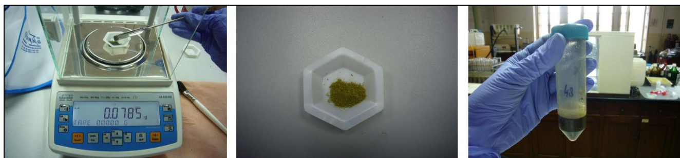
Slika 13. Merenje uzoraka i dodavanje destilovane vode za određivanje nitrata (Izvor: M. Stojanović, 2016)
