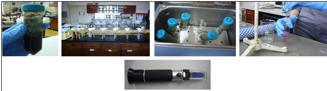
Slika 14. Priprema, filtracija, titracija uzoraka za ukupne organske kiseline i rastvorljive materije, refraktometar (Izvor: M. Stojanović, 2017)
