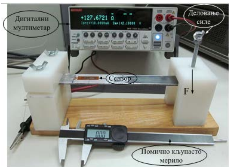
Слика 3. (а) Геометријска структура сензора истезања са означеним геометријским параметрима, (б) Мерни систем: Keithley 2410, дигитално помично кљунасто мерило и сензор, (ц) Три сензора типа меандар, залепљени на конзоли.
