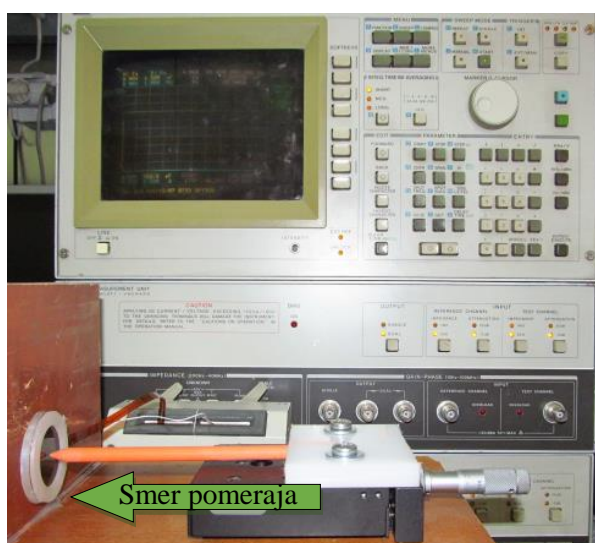
Slika 3. Merna postavka za karakterizaciju novog prototipa kapacitivnog senzora pomeraja izrađenog u 3D aditivnoj tehnologiji.
