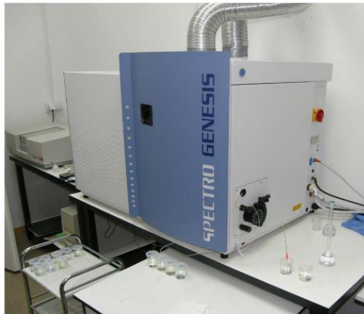
Slika 3.10. Instrument sa induktivno spregnutom plazmom - optičko emisijom spektrometrijom (ICP-OES, Spectro Genesis EOP II, Spectro Analytical Instruments GmbH, Kleve, Germany).
